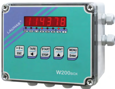
W200BOX - Versión en caja hermética IP67 de policarbonato. Dimensiones 170x140x95mm, cuatro orificios de fijación Ø4mm (distancia entre orificios 152x122mm). Seis prensacables PG9 (tipo "P").
