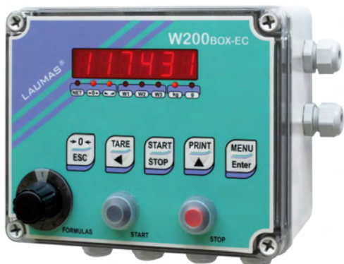
W200BOXEC - Versión en caja hermética IP64 de policarbonato. Dimensiones 170x140x95mm, cuatro orificios de fijación Ø4mm (distancia entre orificios 152x122mm). Seis prensacables PG9 (tipo "P"). Provista de conmutador externo para la selección de la fórmula (opción EC), pulsadores de Start y Stop.
