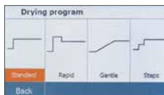
Cuatro perfiles de secado
